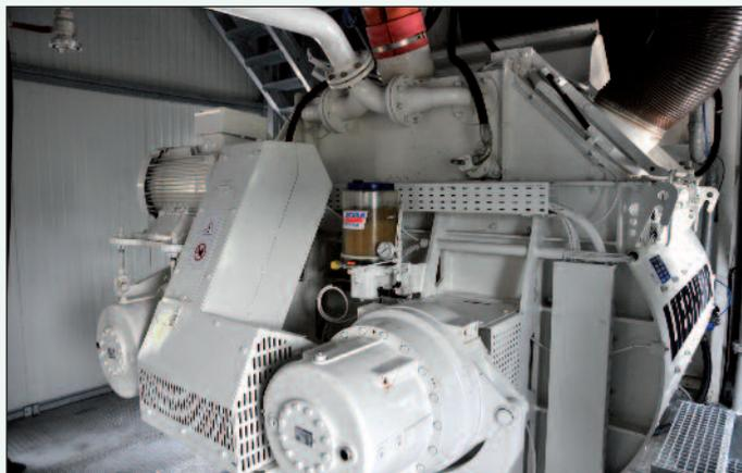
Figura 2 - Il mixer ad asse orizzontale della capacità 2,25 m<sup>3</sup>
